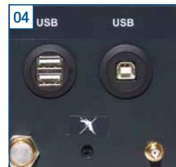
Anschlüsse für PC via USB, Drucker und Bluetooth-Antenne an der Rückseite.
