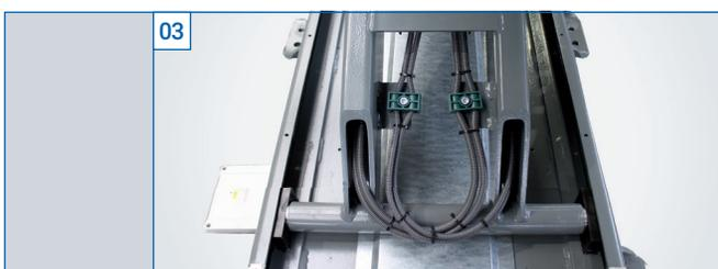
Kabel und Hydraulikschläuche sind innerhalb der Scheinrohre verlegt und in Energieführungsketten geführt. Optimaler Schutz vor Beschädigung!
