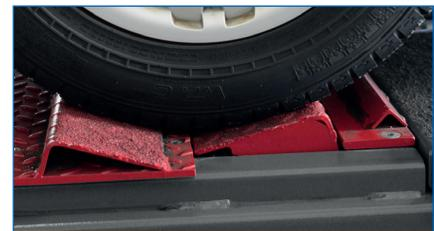
Hintere Prismenhälfte wird automati-sch zur Achsprüfung ausgefahren.
