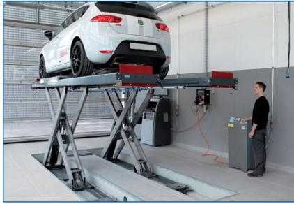
Nutzhöhe von min. 1850\*\* mm bei Einbau in Streifenfundament.
