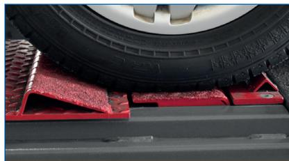
Hintere Prismenhälfte wird automati-sch abge-senkt, alle vier Radaufstandspunkte sind höhen-gleich.
