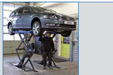
Sehr große Auszugslänge der Aufnahmeplatten (1550 – 2100 mm), dadurch ist das Anheben auch von kleineren Transportern möglich.
