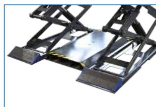
Mit dem Mobilrahmen ist die Hebebühne mit einem herkömmlichen Hubwagen oder Stapler einfach und schnell örtlich versetzbar. Eine Verankerung der Hebebühne am Fußboden ist nicht notwendig. Der Montagerahmen ist freitragend und benötigt lediglich einen befestigten Untergrund. Die Überfahrhöhe der Bühne vergrößert sich nur um 12 mm (TWIN F IV 3.5 A).
