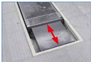
Durch Fundament-Ausgleichskästen (im Lieferumfang) sind die beiden Auszüge auch im abgelassenen Zustand der Hebebühne längenverstellbar. Die Hebebühne kann beim Senkvorgang komplett abgelassen werden, ohne vorher die Auszüge einschieben zu müssen (TWIN F IV 3.5 U).
