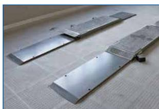
Überfahrrampen um die Überfahrhöhe der bodenauf liegend montierten Hebebühne um 40 mm (TWIN F IV 3.5 A) zu verringern.
