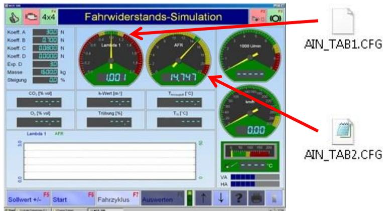
Zusätzlich möglich: Uhr für Lambda. Statt Motordrehzahl kann Lambdawert angezeigt werden.
