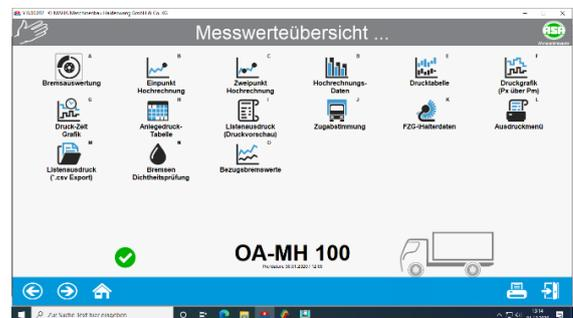
Bremsauswertung: Einzelne Messwerte können ausgewählt und angezeigt werden. Über das Drucker-Icon kann das Drucker-Menü zum Ausdruck der Resultate geöffnet werden.
