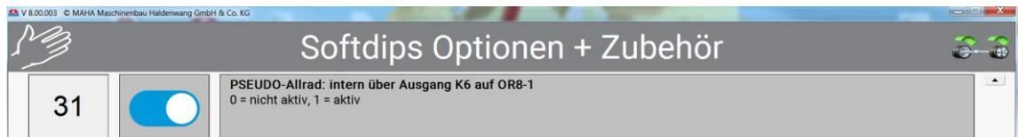
Während der Prüfung (vor Start der Motoren) kann über das Icon <4WD> die Pseudo-Allrad Messung aktiviert werden.
