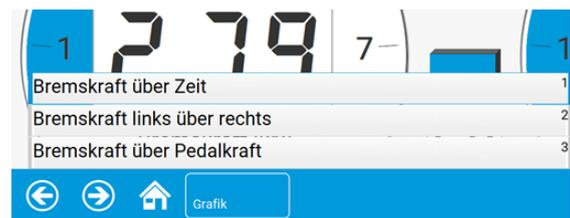
Hier wird die Bremskraft jeweils links über rechts dargestellt. Die Werte sind rechts in kN angegeben und deren Differenz ist in Prozent ablesbar.
