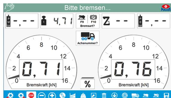
Es werden keine Eingaben akzeptiert, die größer sind als die maximale Endlast, welche mit dem Schlüsselschalter am Hydraulikaggregat voreingestellt wurde.
