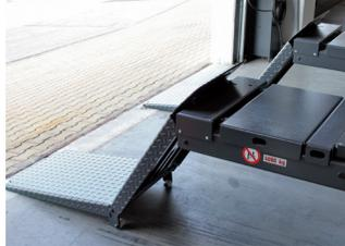
Klapp-Auffahrrampe bei hohen Fahrflächen oder geringem Auffahrwinkel
