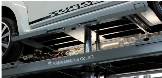
Fahrflächen-Hebebühnen mit Plattform-Radfreiheber, Schwelleraufnahme Traglast 3,5 t
