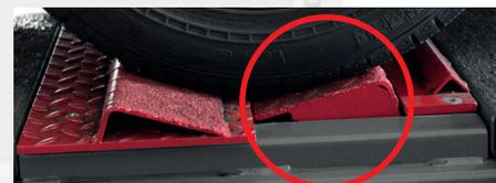
Hintere Prismenhälfte wird automatisch zur Achsprüfung ausgefahren
