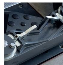
Schwenkarmträger mit Werkzeugablage.
