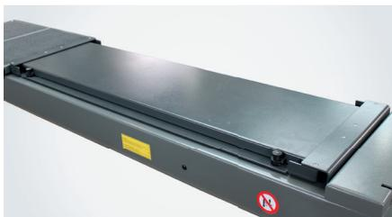
Schiebeplatten mit Querbewegung von 60 mm.
