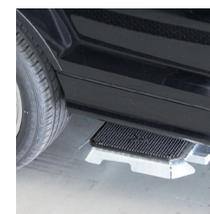
Die Auszüge mit speziellen Gummiauflagen sind besonders geeignet zur schnellen und sicheren Aufnahme der Fahrzeuge.
