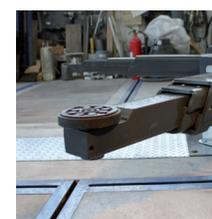
Unterschwenkhöhe am Aufnahmeteller von 101 mm
