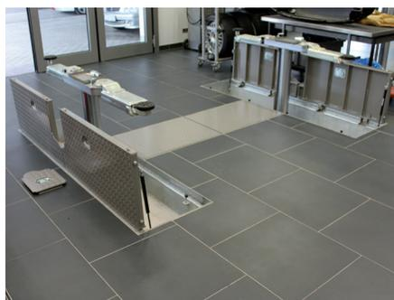
Rahmensystem mit Abdeckplatten, komplett feuerverzinkt
