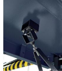
Befestigungssystem und Arretierung der Fahrflächenabstützung.
