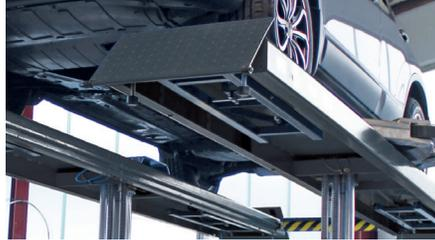
Sicheres und einfaches Aufbewahren der Fahrflächenstützen in der Fahrfläche.
