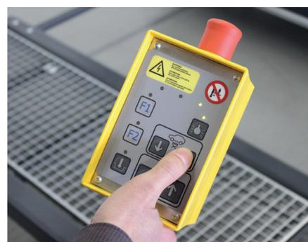
Steuerung mit Kabelfernbedienung
