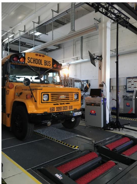
El autobús escolar estadounidense amarillo sobre el nuevo frenómetro digital CONNECT Camión.
